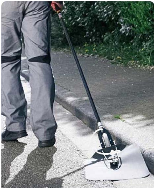
W przypadku sondy dywanowej koniec sondy spoczywa na wsporniku na kółkach, pokrytym gumową matą.
