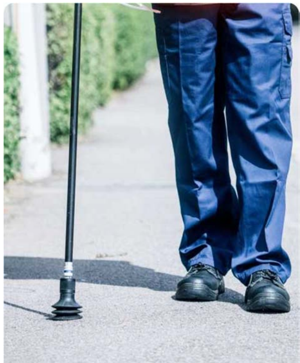
Kontrola przeprowadzana jest za pomocą gumowego dzwonka, trzymając sondę jak kij narciarski i stukając w podłoże podczas marszu do w stylu nordic-walking.
