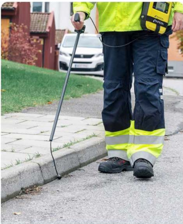
Zastosowanie sondy z miękką powierzchnią pozwala na pobranie próbki podczas chodzenia.
