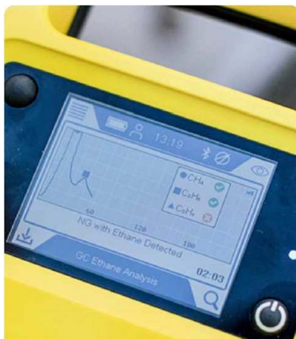
Wbudowany chromatograf gazowy umożliwia analizę gazu na miejscu.
