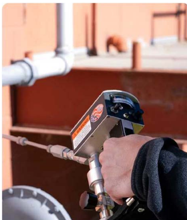
Detektor płomieniowo-jonizacyjny do wykrywania wycieków gazu ziemnego.
