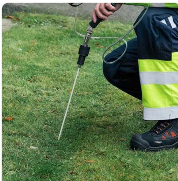
Rura połączona z węzłem to podstawowy sposób pobierania próbek z ziemi.
