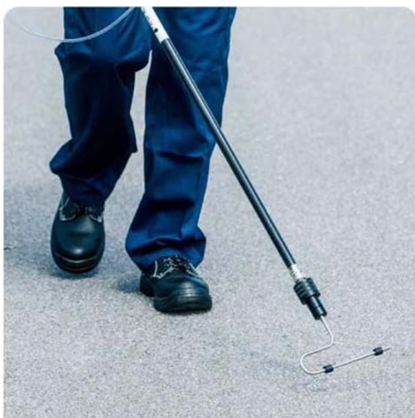
Kontrola za pomocą sondy naziemnej w kształcie anteny może prowadzić do niespójnych wyników ze względu na trudności w utrzymaniu stałej wysokości.
